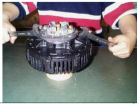
1.Schritt: Abschrauben der Kunsstoffab deckung und Lösen der vier Befestigungs-schrauben des Bürstenhalters. Danach vorsichtig den Bürstenhalter mit zwei Gabelschlüsseln nach Oben hebeln.
