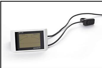
Die Bedieneinheit kann sowohl an der linken, als auch der rechten Lenkerseite oder auch in dessen Mitte montiert werden. Ggf. müssen Bedienelemente wie z.B. Gangschalthebel o.ä. auf der jeweils andern Lenkerseite angebracht werden. Die Halterung ist optional für einen Lenkerdurchmesser von Ø22 mm oder Ø31,8 mm erhältlich.
